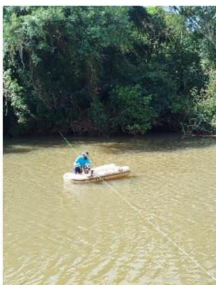
Figura 5: Medição de descarga líquida.
