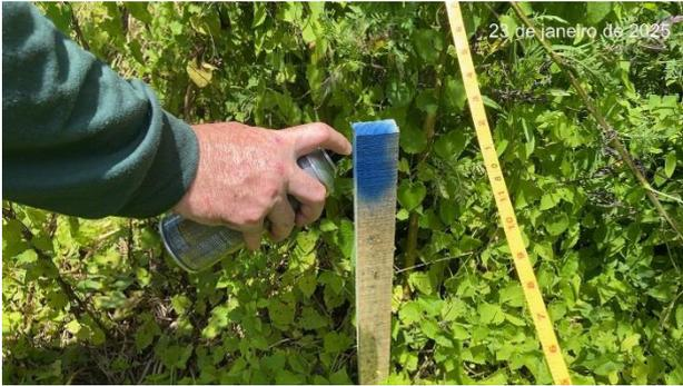
FOTO 4 – EXTREMIDADE SUPERIOR DAS ESTACAS PINTADA DE AZUL, PARA MELHOR IDENTIFICAÇÃO POSTERIOR EM CAMPO (JAN. 2025)
