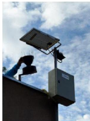
Figura 2: Detalhe do pluviômetro.
