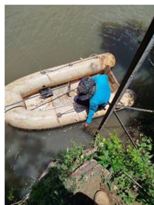
Figura 6: Coleta de sedimentos em suspensão.
