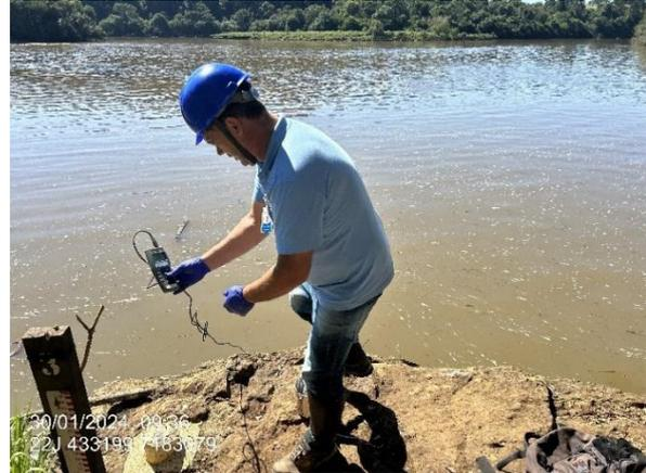
FOTO 2 – UTILIZAÇÃO DA SONDA PARA MEDIÇÕES *IN SITU* EM P4 (CAMPANHA 7)
