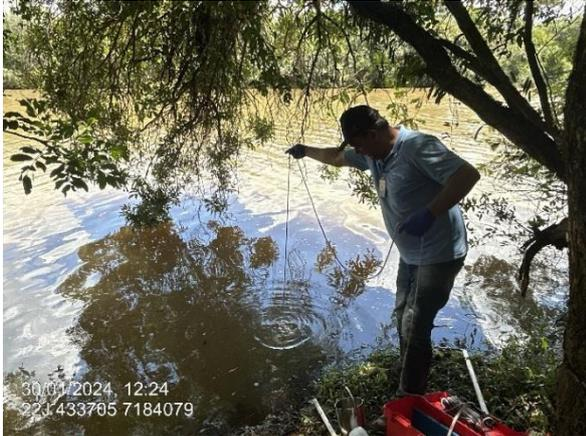
FOTO 1 – COLETA DA AMOSTRA DE ÁGUA USANDO GARRAFA VAN DOOR EM P2 (CAMPANHA 7)
