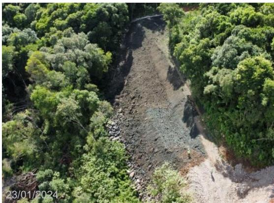
FOTO 18 – PROCESSO EROSIVO E TALUDES DO ACESSO.
