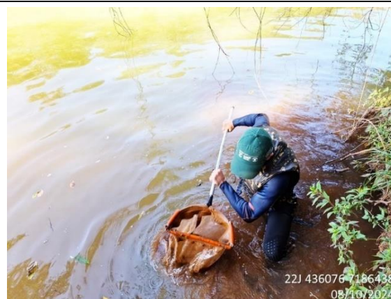
FOTO 86 - SURBER UTILIZADO PARA A CAPTURA DOS MACROINVERTEBRADOS EM MEIO A VEGETAÇÃO MARGINAL DO RIO JORDÃO.
