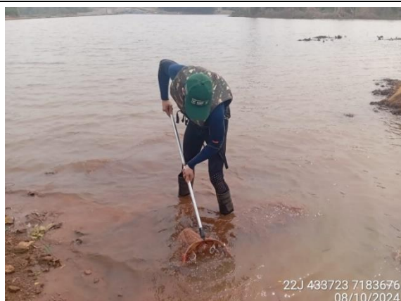
FOTO 85 – SURBER UTILIZADO PARA A CAPTURA DOS MACROINVERTEBRADOS AQUÁTICOS DURANTE A EXECUÇÃO DA QUARTA CAMPANHA DA FASE LO.
